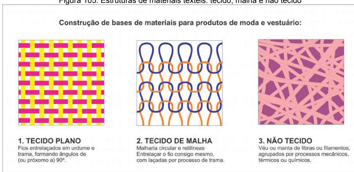
Figura 105: Estruturas de materiais têxteis: tecido, malha e não tecido
