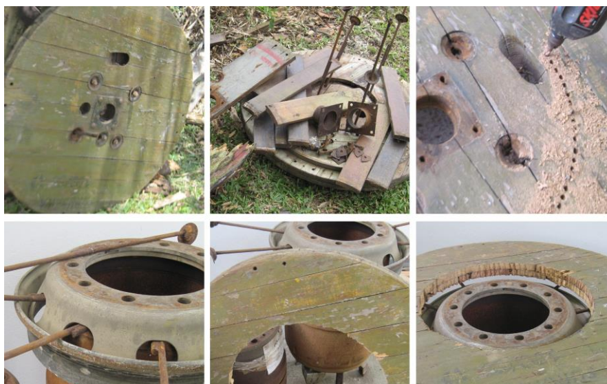
Figura 28– Primeira concepção dos apoiadores utilizando um carretel de madeira.
