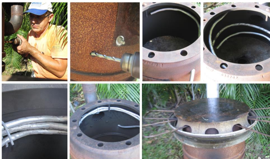
Figura 31 – Adequação da serpentina interna com acesso lateral.
