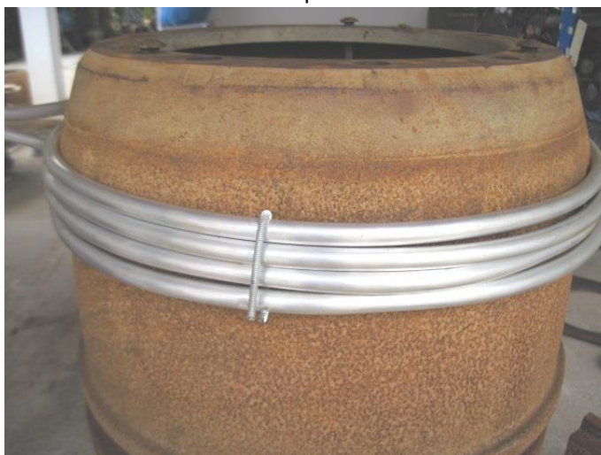
Figura 19 – Serpentina fixada externamente ao corpo do sistema
