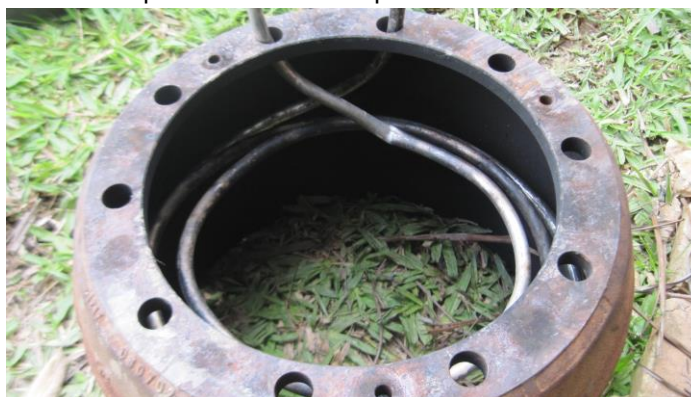
Figura 23 – Serpentina fixada na parte interna do corpo.
