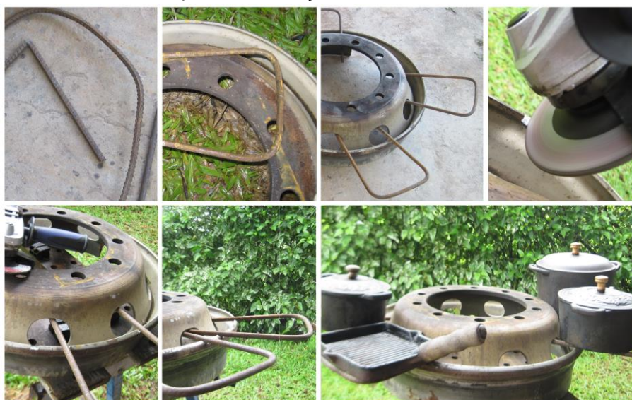
Figura 29 – Desenvolvimento de apoiadores de aço
