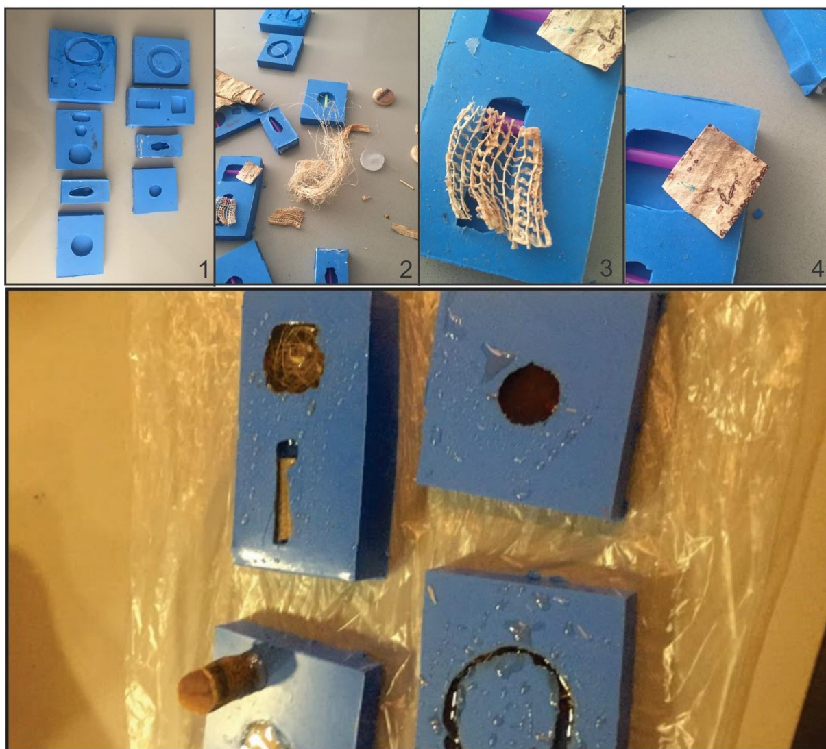
Figura 55 - Confeção de moldes com silicone e aplicação da resina
