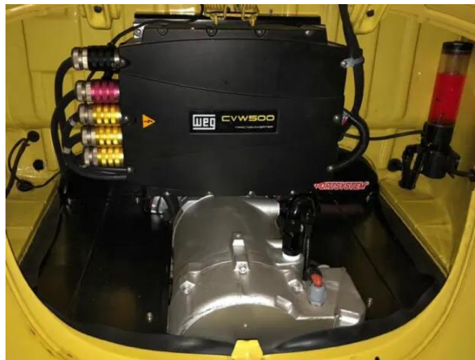
Figura 15 - Detalhe do motor elétrico adaptado em um VW Fusca
