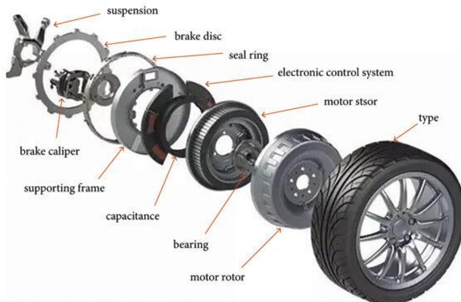
Figura 23 - Vista explodida de cubo e freio similares ao do veículo
