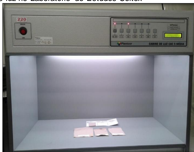
Figura 37 - Cabine de luz no Laboratório de Estudos Coltex
