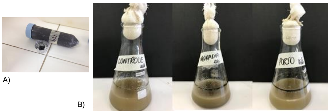
Figura 7. Amostra do sedimento e ativação dos microrganismos. A) Amostra do sedimento do manguezal pesado. B) Meios de enriquecimento líquido com 1 % de óleo de soja inoculado com 1 g de sedimento do manguezal (controle, moradia e porto) após 48 horas. Fonte: a autora
