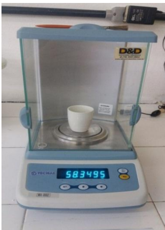
Figura 8 – Balança analítica, usada no teste de umidade.
