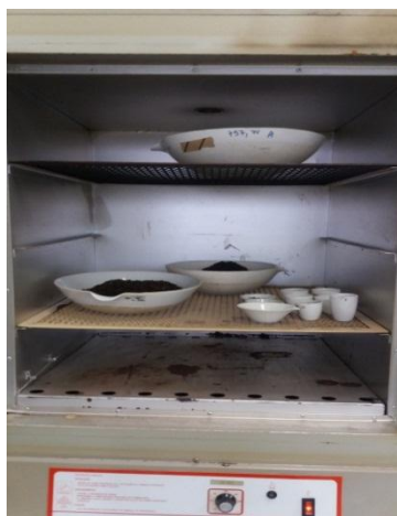
Figura 9 – Estufa contendo as amostras utilizada no teste de umidade
