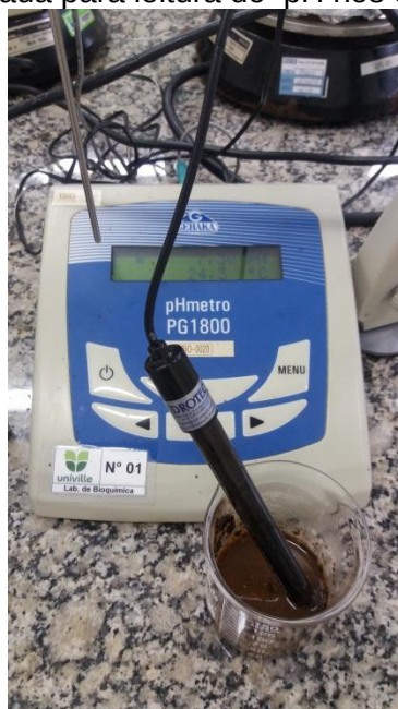
Figura 10 – Sonda utilizada para leitura do pH nos ensaios com as amostras
