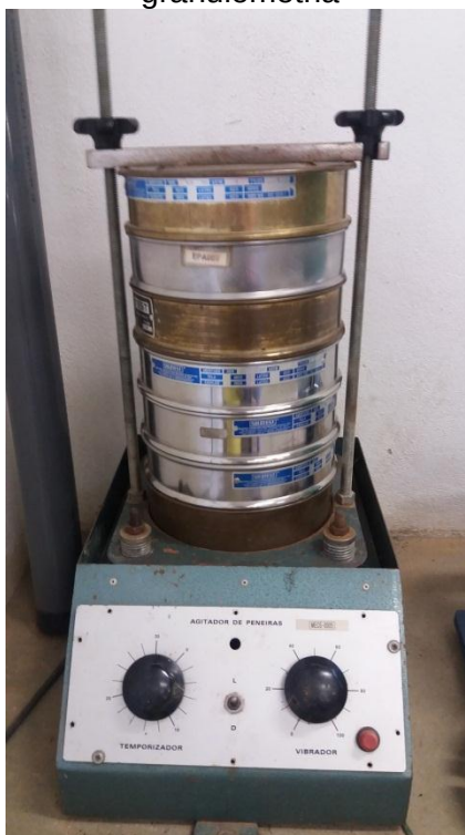
Figura 8 – Equipamento vibrador utilizado para agitar a amostra para o teste de granulometria
