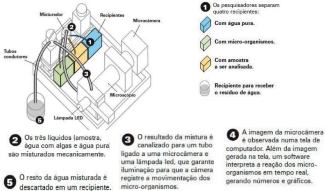
**Figura 13.** Esquema de funcionamento do NG TOX.
