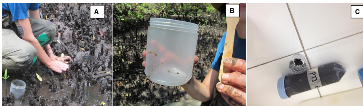
Figura 7 - Procedimento de Coleta do sedimento. [A] Processo da retirada do sedimento utilizando amostrador. [B] Material utilizado na homogeneização das sub - amostras. [C] Sedimento devidamente armazenados em tubos Falcon.
