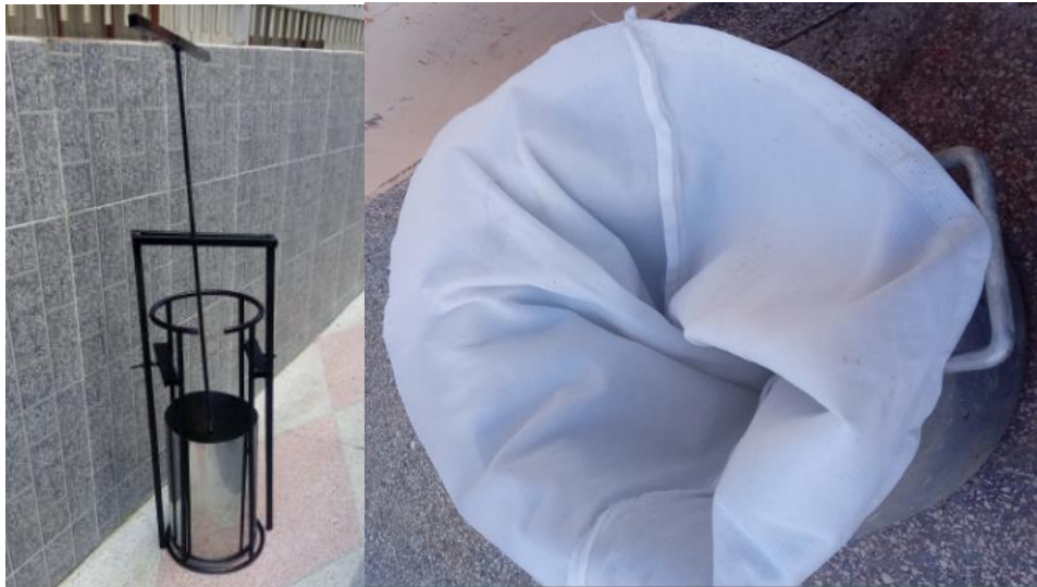
Figura 2: Prensa mecânica para desidratação do Trub o lado direito e saco de tecido para retenção dos solidos no lado esquerdo
