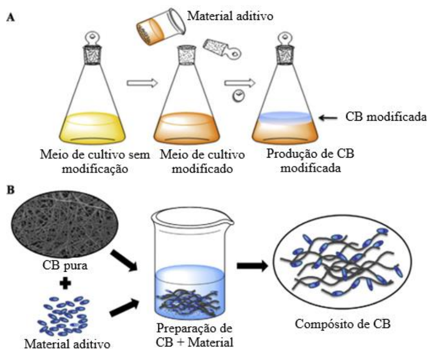
Figura 7 – Esquema representando métodos de modificação da CB: A) Modificação in-situ e B) Modificação ex-situ
