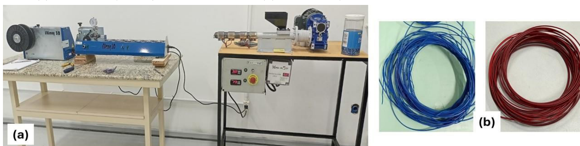
Figura 2 - (a) sistema de produção de filamentos e (b) filamentos produzidos.
